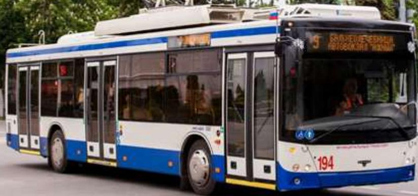
**Троллейбус** это городской вид транспорта, который работает от электрического тока. Его штанги соприкасаются с проводами, по которым идёт ток. Вследствие чего двигатель троллейбуса может работать. У троллейбуса много положительных, он не выделяет вредных выбросов, как автомобиль и не ограничен в движении, как трамвай. Он может развивать большую скорость и практически бесшумен.
